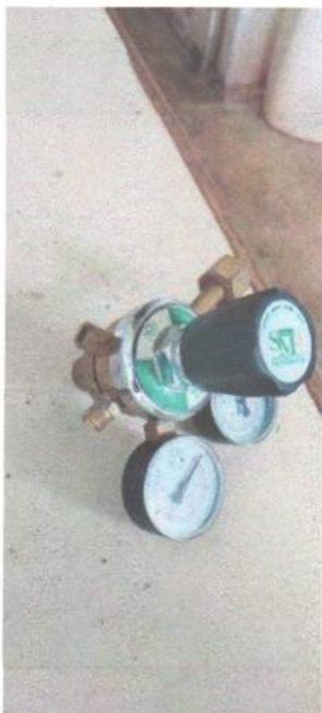
Troca valvula reguladora de pressão
