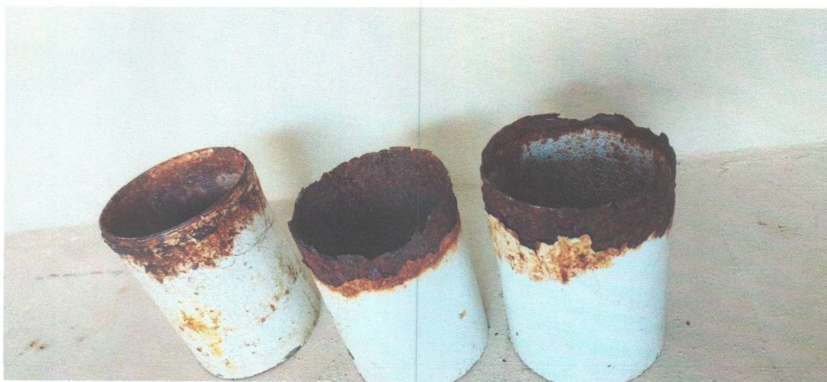
Detalhamento dos pontos com oxidação severa e perda de material.
